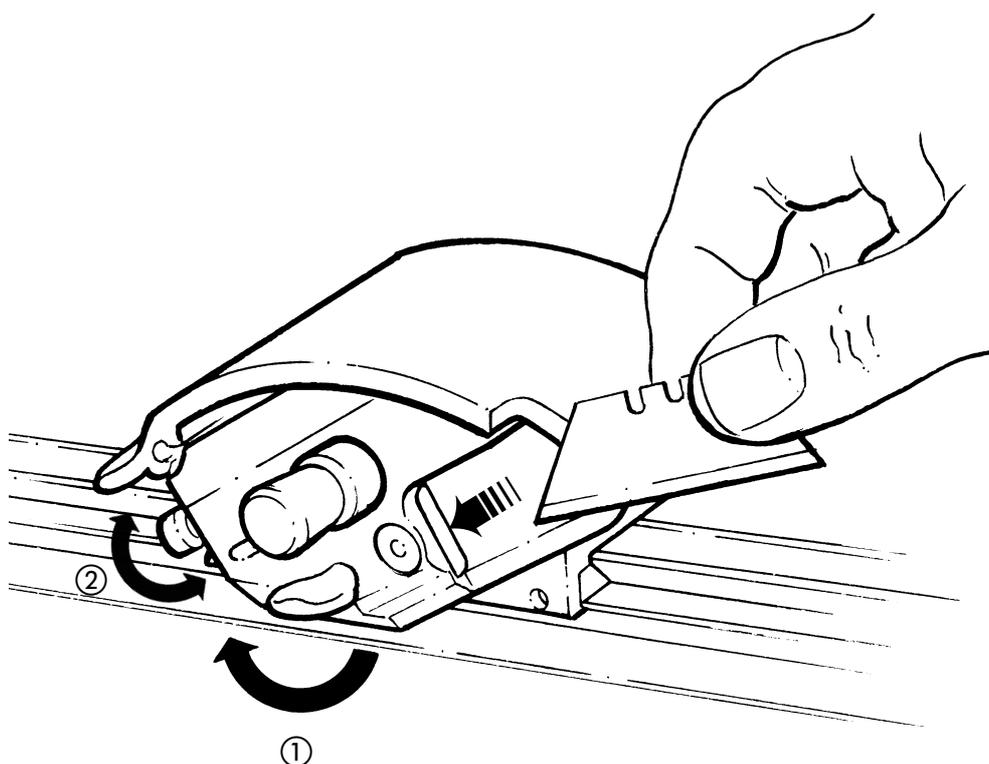
**Inserimento e settaggio della lama**
