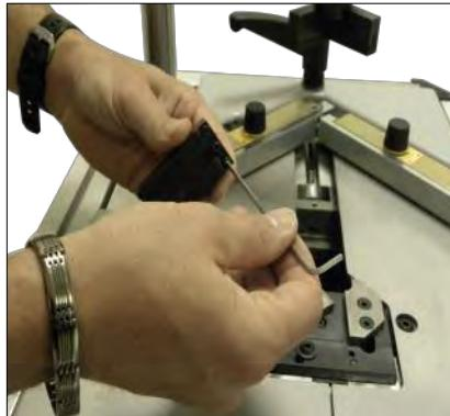
Séparer les plaques de la tête et les nettoyer à l'aide d'un chiffon ainsi que d'un spray lubrifiant. Ceci fait, réassembler la tête, les deux plus petites vis sont destinées au petit guide carré qui est à l'intérieur de la tête.
