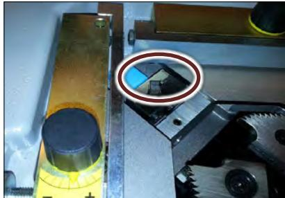
Utiliser l'outils fourni dans la boîte d'accessoires afin de dégager cette agrafe. L'introduire de 6mm dans la tête de distribution puis retirer l'outil. Il doit alors être possible de dégager le chargeur d'agrafes.
